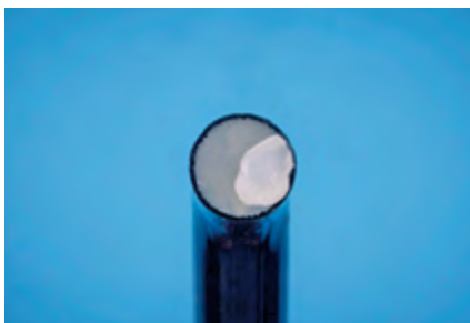
Abb. 6 Beispiel von verunreinigtem Lichtaustrittsfenster
